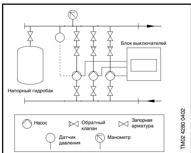
**Бустерный модуль Hydro Multi-E с тремя насосами, оборудованными трехфазными электродвигателями**
