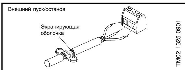
Для соединений с ШИНОЙ связи необходимо использовать 2-жильный экранированный кабель. Оба конца экранирующей оболочки должны подключаться к контактному зажиму Y.
