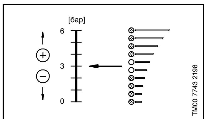
**Пример:** Насос находится в нерегулируемом режиме эксплуатации.
