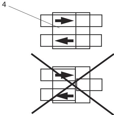
Переключающий клапан (4) установить так, чтобы циркуляция шла через входное отверстие в направлении стрелки (см. рисунок). Включить сетевой выключатель (2).
